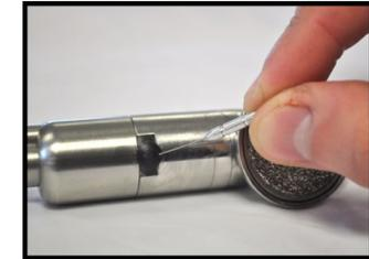
Si l'eau ne s'écoule pas, utiliser un petit tournevis plat (2.0x0.4 AN 2x75 FACOM) pour soulever et retirer la buse défectueuse et remplacer la buse défectueuse par une
