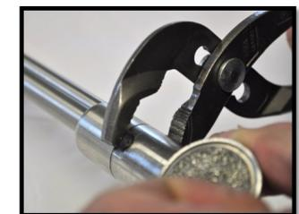
Veiller à indexer l'orifice de la buse vers la fraise.
