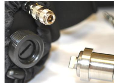
Brancher les connexions hydrauliques et électriques (veiller à ce que la batterie soit préalablement chargée - cf. instructions section batterie).
